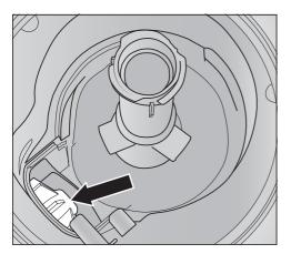
Unter der Abdeckung befindet sich die Ablaufpumpe (Pfeil).
