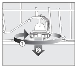
■ Drehen Sie die Verschraubung des mittleren Sprüharms im Uhrzeigersinn ① (siehe Abbildung) und nehmen Sie den Sprüharm ab ②.
