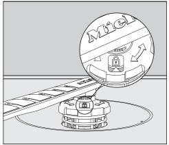
■ Drehen Sie die Verschraubung im Uhrzeigersinn, bis der Pfeil im Sichtfenster auf das Schlosssymbol ⊕ zeigt.
