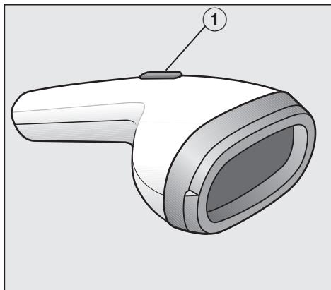
Med tasten ① på steameren styres dampputslippene.
